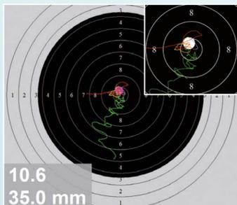
Trajet de la ligne de mire incluant la rentrée en cible (vert), le maintien de la visée terminale (jaune), le départ du coup (bleu), la réaction de l'arme et la tenue après le départ du coup (rouge).
