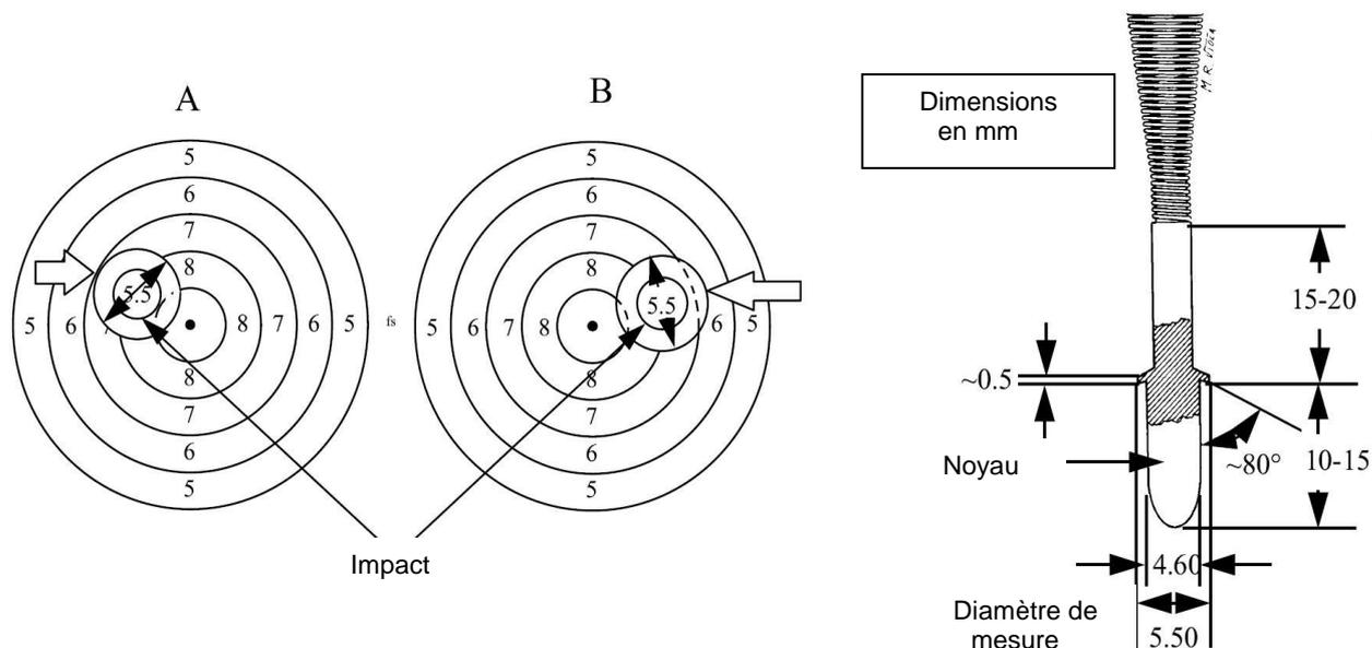
« A » représente un impact douteux avec la jauge en place. Le bord extérieur du collet est intérieur à la zone 7. L'impact est jugé POSITIF soit 9.
