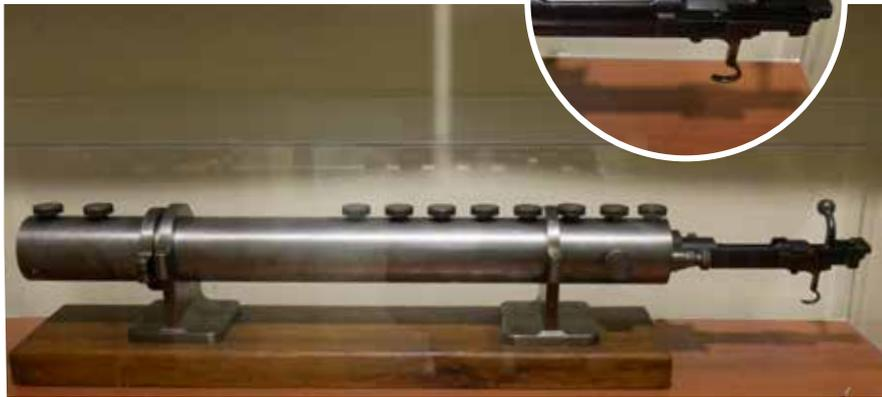
**Canon d'essai manométrique ancien, à «crusher». Les logements au-dessus recevaient des cylindres de cuivre. Leur déformation indiquait la pression.**
