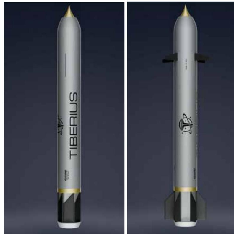
L'engin déplie ses ailettes de guidage une fois en vol. Il peut être coiffé d'une pointe perçant les blindages.
